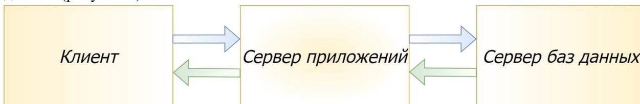
Рисунок 1 – Трехзвенная клиент-серверная архитектура
